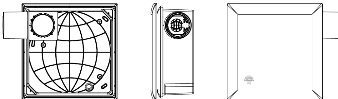
Rys. 4.4: Położenie króćca w wentylatorach eVI S
