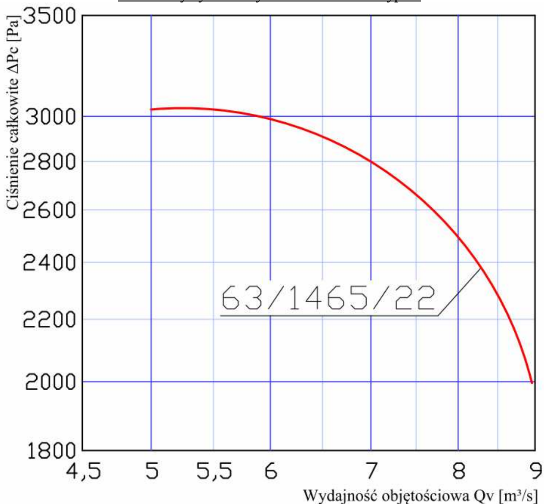
Charakterystyka wentylatora z wirnikiem typu a
