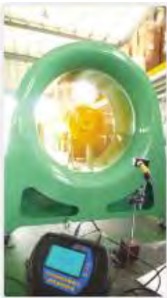
震動頻譜分析 VIBRATION ANALYZER
